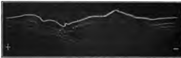
Abb. 349. Funkenentladungen mit Vorentladungen.
